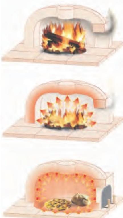
Vid bak av pizza så är elden igång hela tiden med en så kallad underhållslåga som ständigt återför värme till både golv och tak med rätt teknik så kan man hålla en hög (470 °C) under hur lång tid som man vill. Detta betyder inte att mer massa är bättre. En alltför stor massa gör att den absorberar för mycket värme som kommer att leda till att du att bränner mer ved än vad som behövs och det tar för lång tid för ugnen att komma upp till rätt temperatur.
