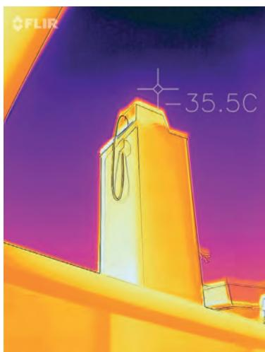
Temperaturen i vedugnen är ca 470°C och temperatur på vattnångan som kommer ut är 35,5°C. Bild tagen med värmekamera
